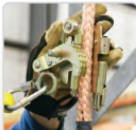
5. Установите канатный зажим с амортизатором на канате, и, присоедините его, при помощи карабина, к страховочному поясу
