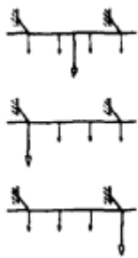
Рисунок Д.4 — Размещение расчетных нагрузок на коллективной верхней страховке
