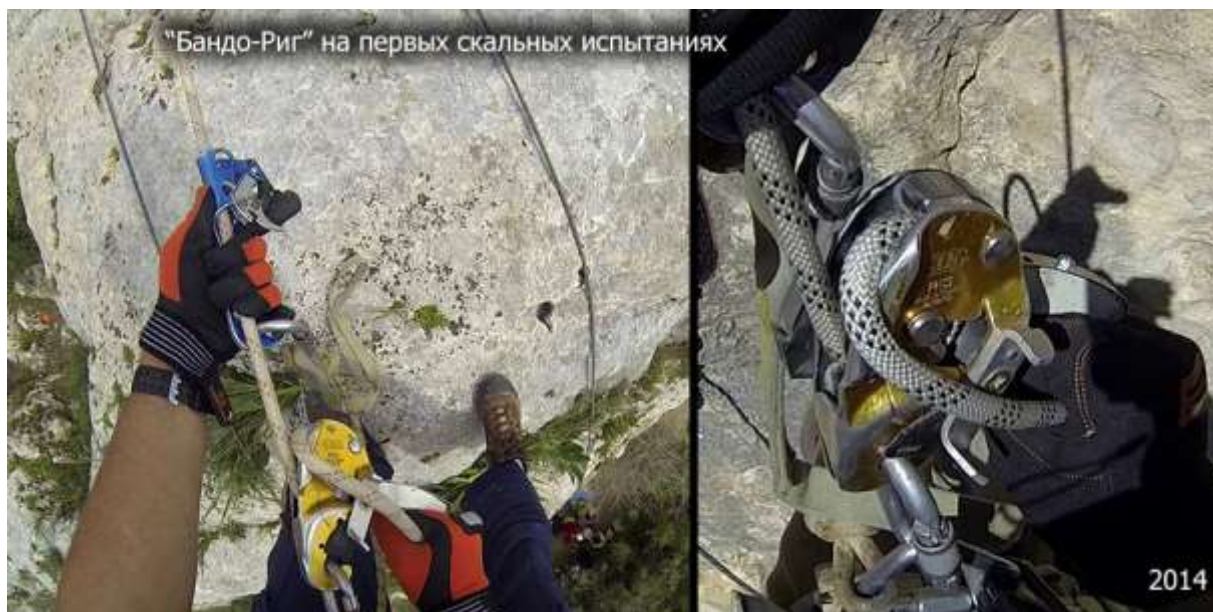
Рис.29. Первые полевые испытания «Бандорига» на скалах Бейт-Орен, 28 марта 2014 года – во время которых я всерьез задумался о скручивании веревки при традиционном ее положении.
