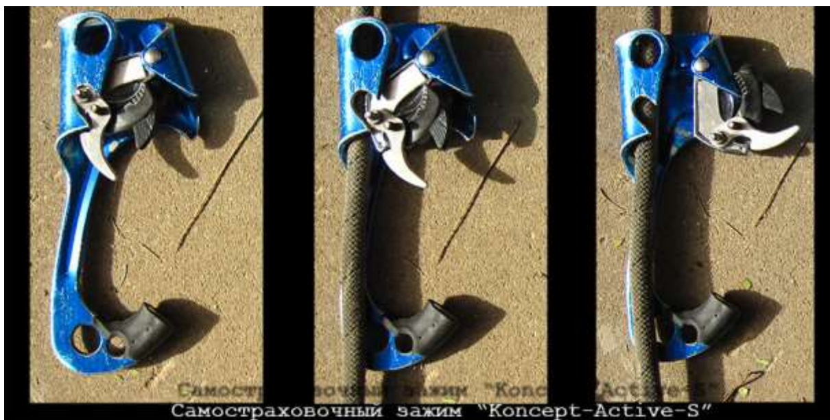
Рис. 12. Страховочно-ходовой зажим «Концепт Эktiv», в котором собраны концептуально-новые элементы, не имеющие аналогов в мире. Этот первый образец сделан мной 18 января 2013 года: на нем даже крепежные болтики курка пока не отпилены. «Koncept Active S» означает «small» - самый маленький из трех размеров активных рычажков, которые я изготовил и опробовал.
