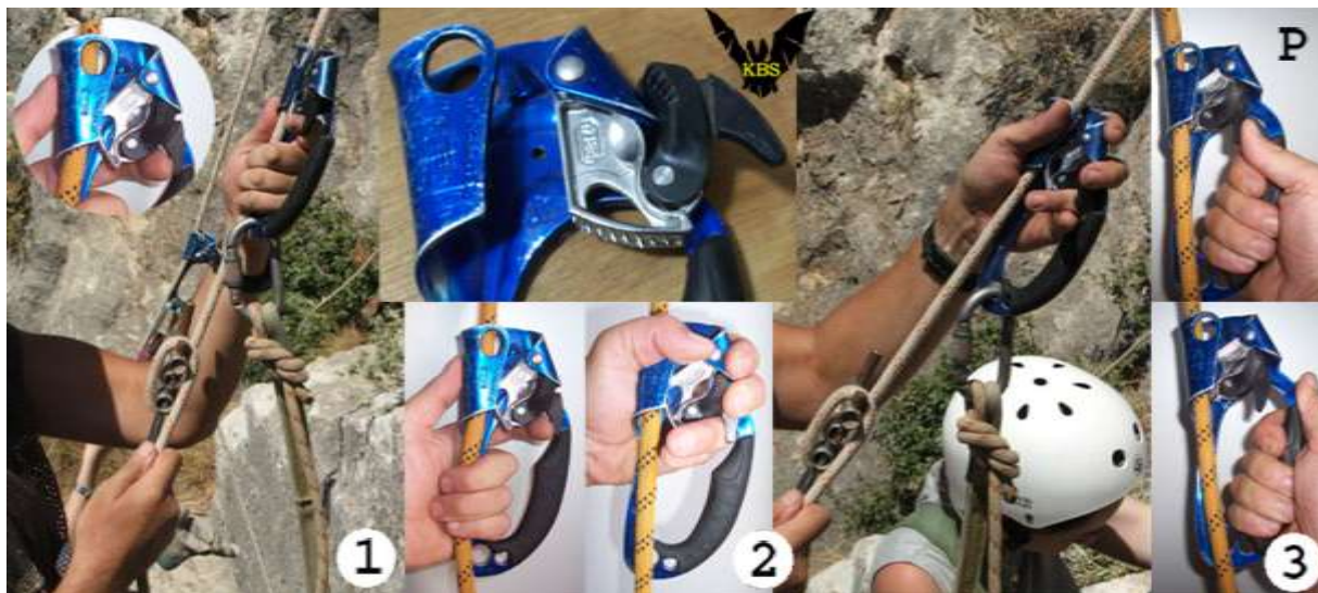
Рис.5. Пуани «Petzl Ascension» с курком «Рефлекс» – первое представление в 2006 году: 1 – отведение указательным пальцем; 2 – отведение безымянным пальцем; 3 – возможность поддавливания курка большим пальцем при подъеме – начало зарождения идеи «Активного привода кулачков эксцентриковых зажимов».
