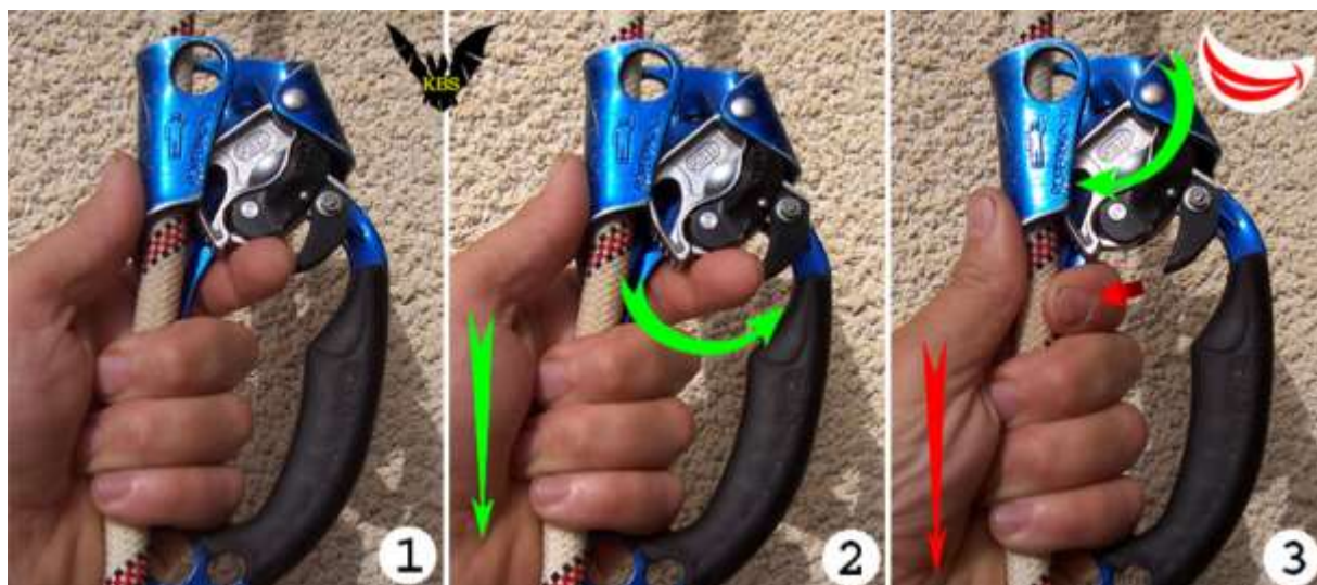
Рис. 6. Складной курок «Рефлекс» первой модели января 2007 года: 1 – положение пальца на курке первой фалангой; 2 – отведение при спуске; 3 – срабатывание при хватательной реакции и просто в планируемый момент.
