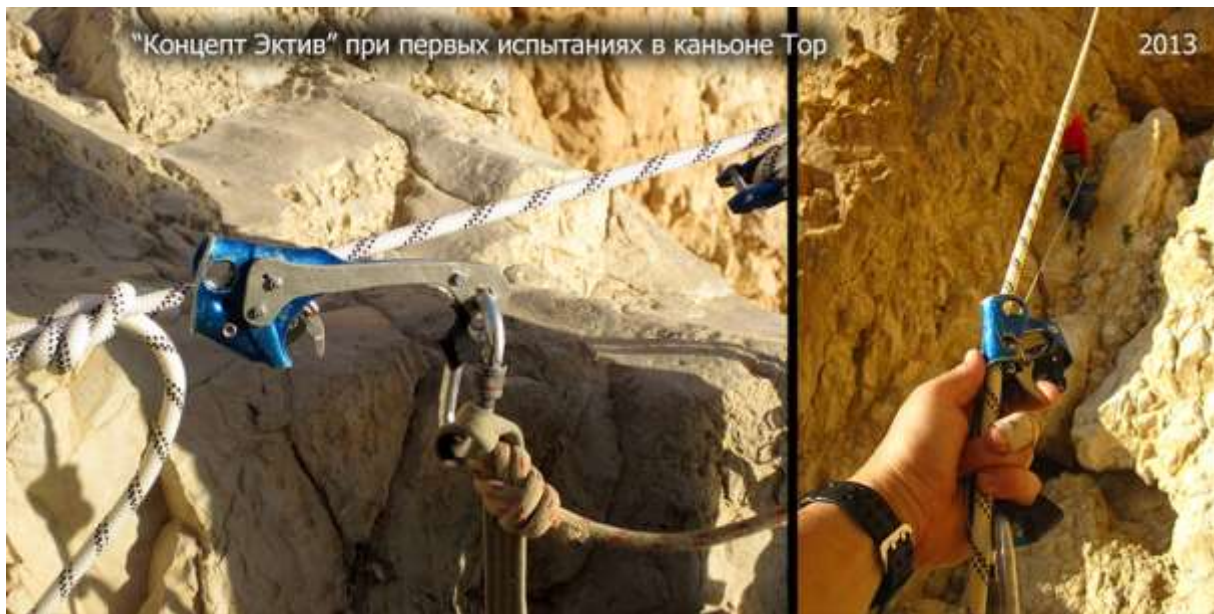
Рис.14. Фото с первых полевых испытаний новой концепции зажима 22 февраля 2013 года в каньоне Тор на западном побережье Мертвого моря, Израиль. слева – «обратная сторона медали» - усиление рамы зажима дюралевой накладкой; справа – рапельная подстраховка спускающегося.
