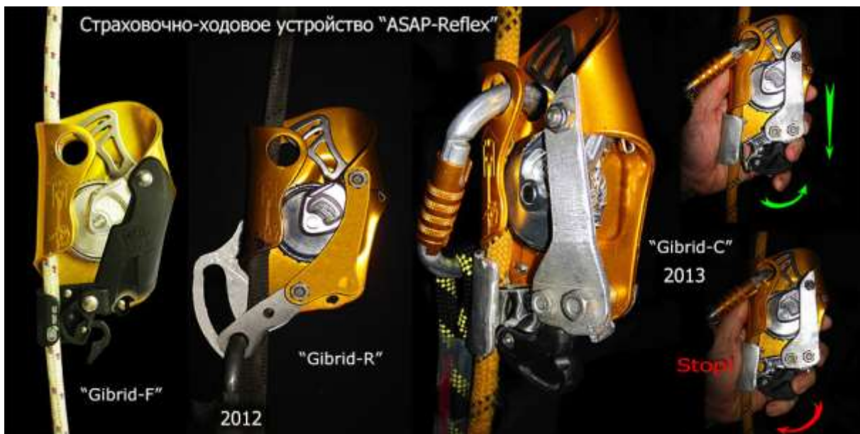
Рис.35. Разные варианты гибрида «ASAP-Reflex» с августа 2012 по февраль 2013 года: - Gibrid-F – комбинация с итальянским зажимом для стопы «Kong Futura» с курком «Рефлекс»; - Gibrid-R – оснащение рычажным стопором вращения зубчатого колеса; - Gibrid-C – комбинация с кулачком от зажима «Petzl Croll» в самодельном корпусе.
