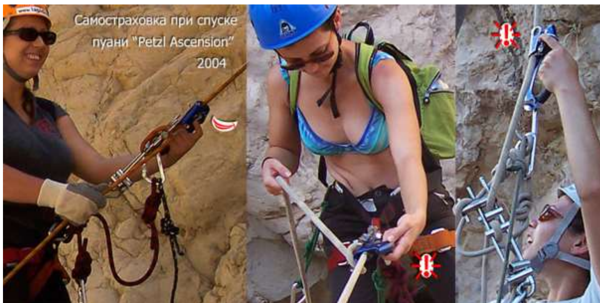
Рис.4. Правильное – на заклепке, и опасное – на рубчатом выступе защелки, положение указательного пальца при самостраховке пуани «Petzl Ascension B17», Израиль, 2004 год.
