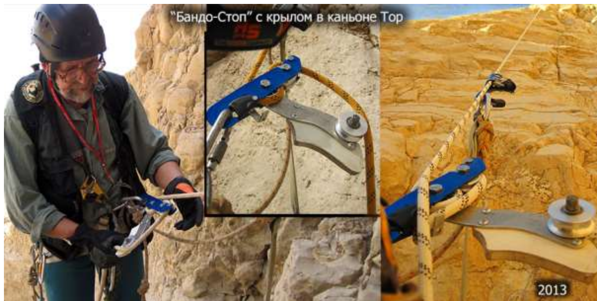
Рис.26. Управление с веревкой над роликом (минимальное трение) и фиксация «Бандо-Стопа» с помощью специального крючка в нижней части неподвижной части корпуса, февраль 2013 года.
