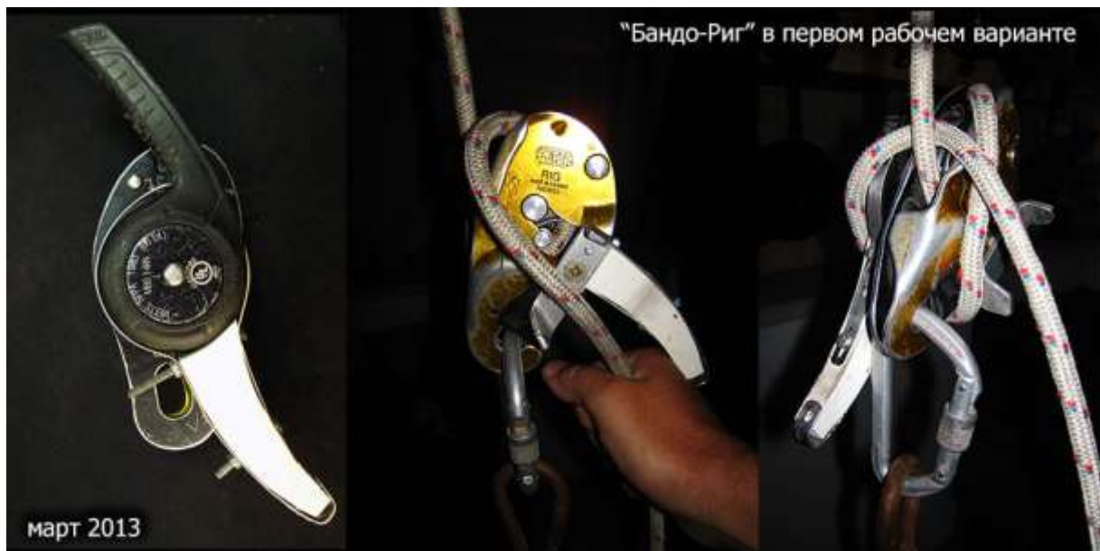
Рис.28. Из «Petzl RIG» легко получается одноручный автоблок:
