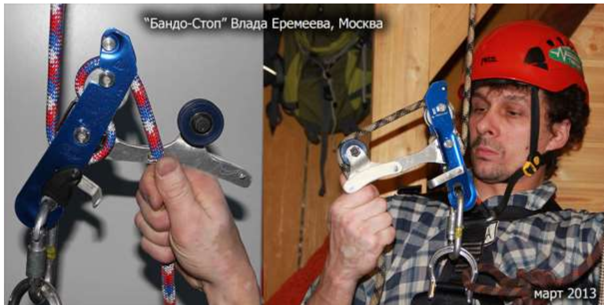
Рис.27. «Бандостоп» Влада Еремеева получил более изящную и эргономичную рукоятку, обеспечивающую широкий диапазон управления торможением, март 2013 года.
