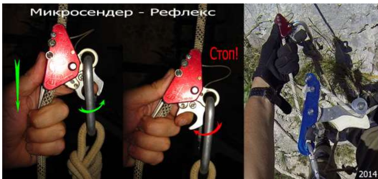
Рис. 2 «Микросендер Рефлекс» в рабочем состоянии: ведение, схватывание, положение руки. Справа – работа в сочетании с одноручным автоблокиратором «Бандостоп», весна 2014 года.
