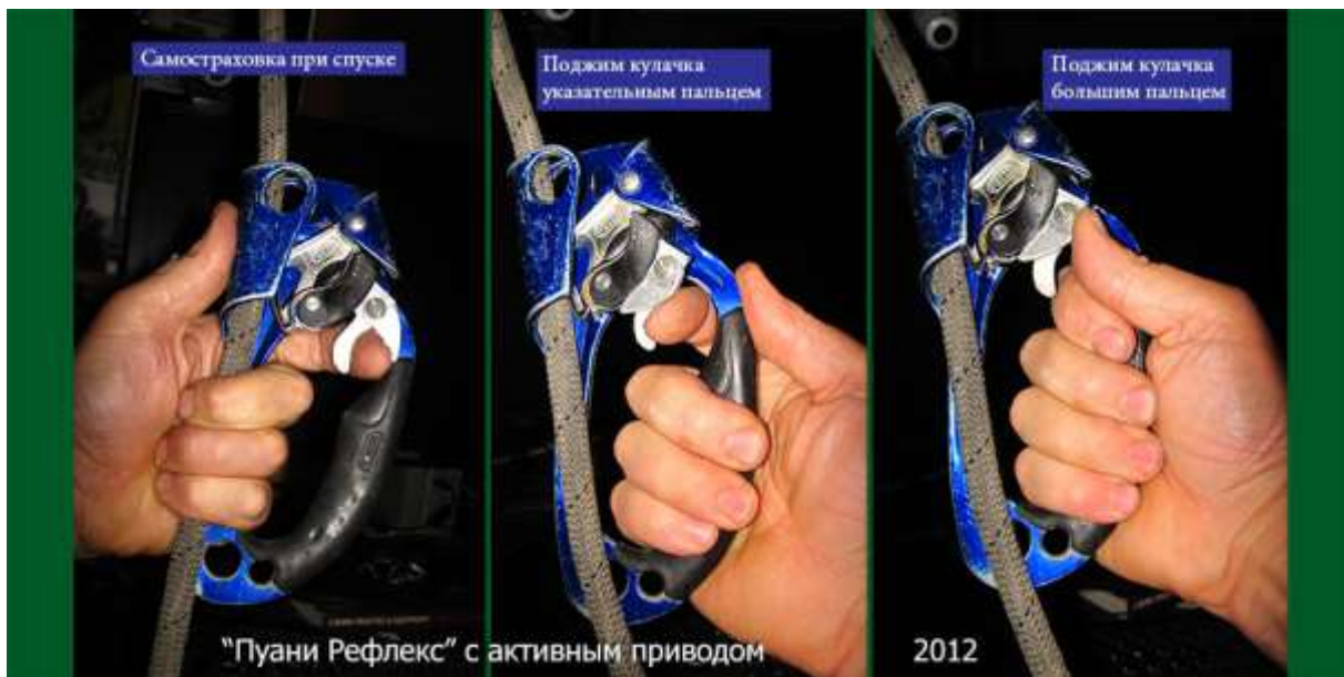
Рис. 11. Первый вариант активной скобы курка «Рефлекс», с креплением к фиксатору кулачка.
