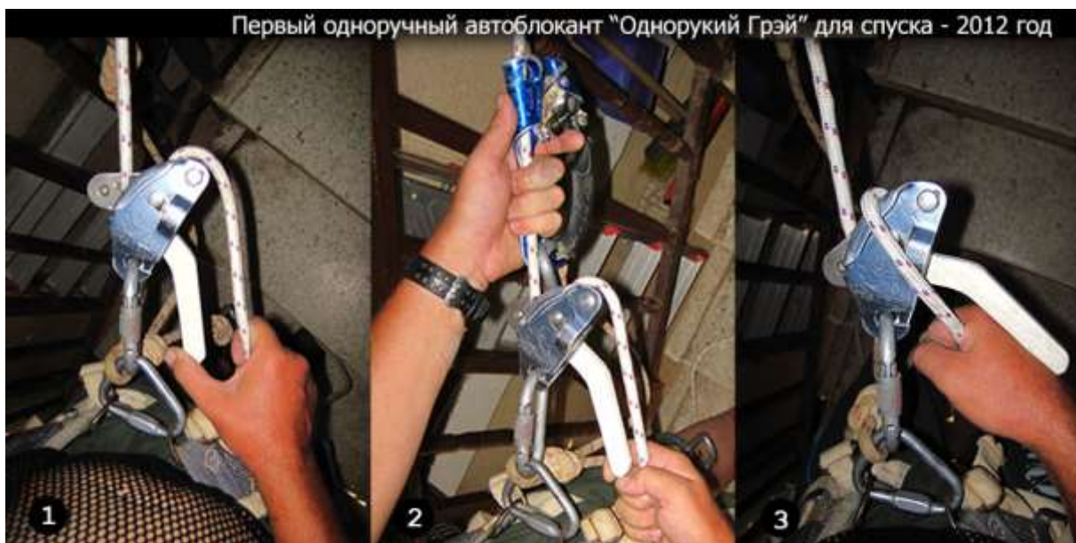
Рис.19. Варианты управления первым вариантом «Грея» с пластмассовой ручкой: 1 и 2 – с S-образным положением веревки, 4 пальца на веревке – 1 отводит ручку; 3 – тыльной стороной управляющей руки с более надежным хватом рапели всеми пальцами и стандартным положением веревки, хотя так можно управлять и при S-образном положении.
