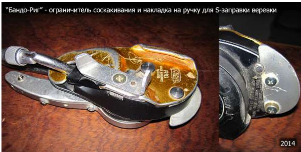
Рис.32. Дюралевая накладка на ручку и ограничитель сползания веревки в ее сторону я сделал где-то в июне 2014 года – важные усовершенствования с точки зрения использования «Бандорига» в спелеотехнике.
