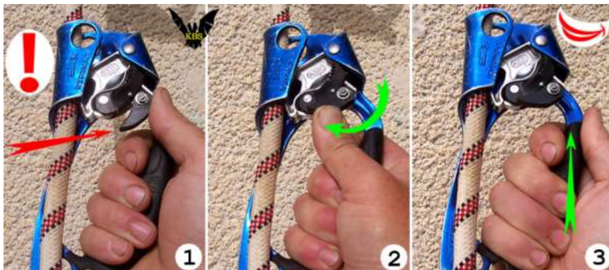
Рис. 7. Примыкание курка «Рефлекс» перед подъемом по веревке:
