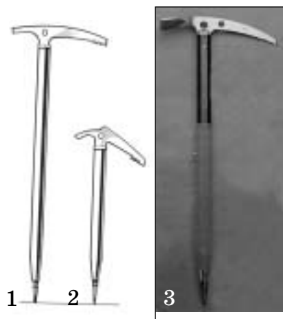
Ледорубы: 1 – длинный; 2 – укороченный для ледовых маршрутов; 3 – одна из многочисленных моделей современного ледоруба
