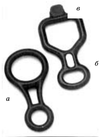
Восьмерка тормозная: а – обычная модель; б – квадратная; в – термостойкий язычок, предохраняющий пальцы от высокой температуры, возникающей от трения в момент спуска
