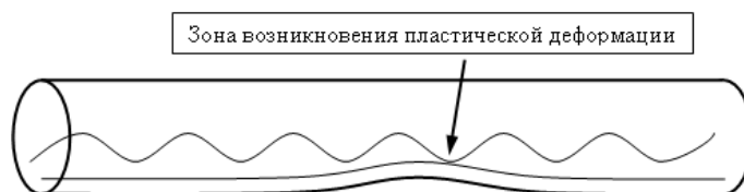
Рис. 8 Деформация волокон при сдавливании
