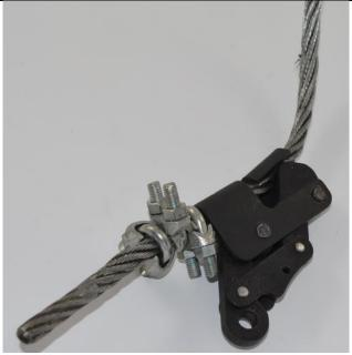
Фото образца после приложения нагрузки в  $20~\kappa H$
