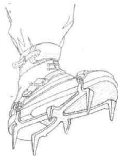
Цельноштампованные кошки с четырьмя основными зубьями.
