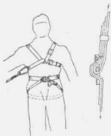
Альпинистский пояс. Справа — закрепление пояса в пятистенной пряжке.
