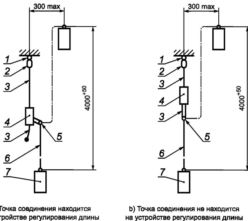
1 — анкерная точка; 2 — концевое соединение; 3 — строп; 4 — устройство регулирования длины; 5 — точка присоединения на подвижном конце стропа; 6 — испытательный строп; 7 — испытательный груз массой 100 кг
