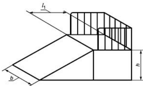
Рисунок 9 - Трамплин с платформой
