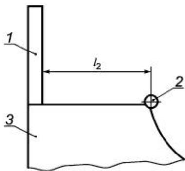
1 - ограждение платформы; 2 - ребро; 3 - пайп
