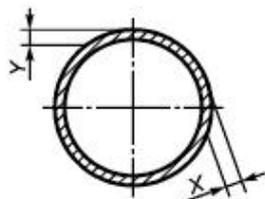
Рисунок 4 - Выступ ребра по краю поверхности катания
