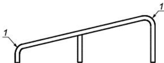
1 - внешний радиус закругления или изгиб под углом 45°
