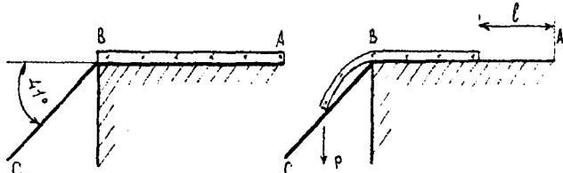
Рис. 2. Схемы испытаний по определению показателя жесткости образца веревки
