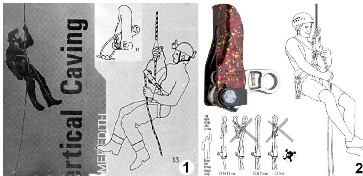
Рис. 13. Специализированный страховочный зажим «Petzl Shunt» и способы его использования для само страховки при спуске.
